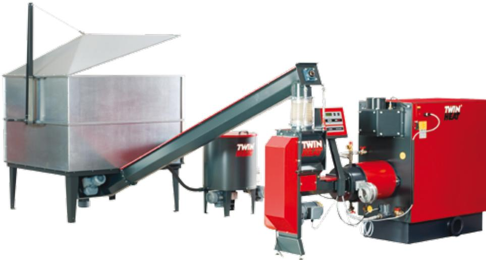
Cuando se queman combustibles homogéneos (uniformes) como por ejemplo, pellets y grano de cereal, los usuarios suelen disponer de silos de alimentación tradicionales instalados en el interior o exterior, o en un sótano. En la mayoría de los casos, el combustible se suministra mediante cisternas y se inyecta en el silo. El combustible se transporta al quemador por medio de un tornillo sinfín rígido o flexible.
