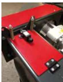
El transportador sinfín tiene instalada en su parte superior una tapa con un resorte y un interruptor eléctrico, que se acciona en caso de que se acumule el combustible
